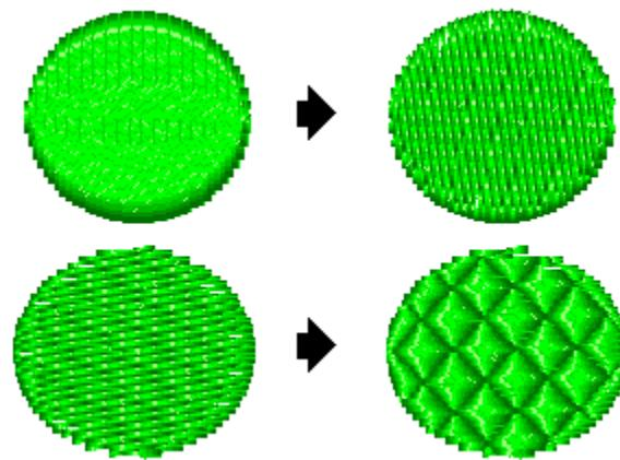
حداقل پهنهای ساتین را برای تبدیل تعیین می‌کند. بر فرض مثال اکر مقدار این پارامتر را روی 4mm قرار دهید، ساتین‌هایی که پهنهای آنها بیشتر از چهار میلی‌متر باشند به تاتامی تبدیل می‌شوند.
